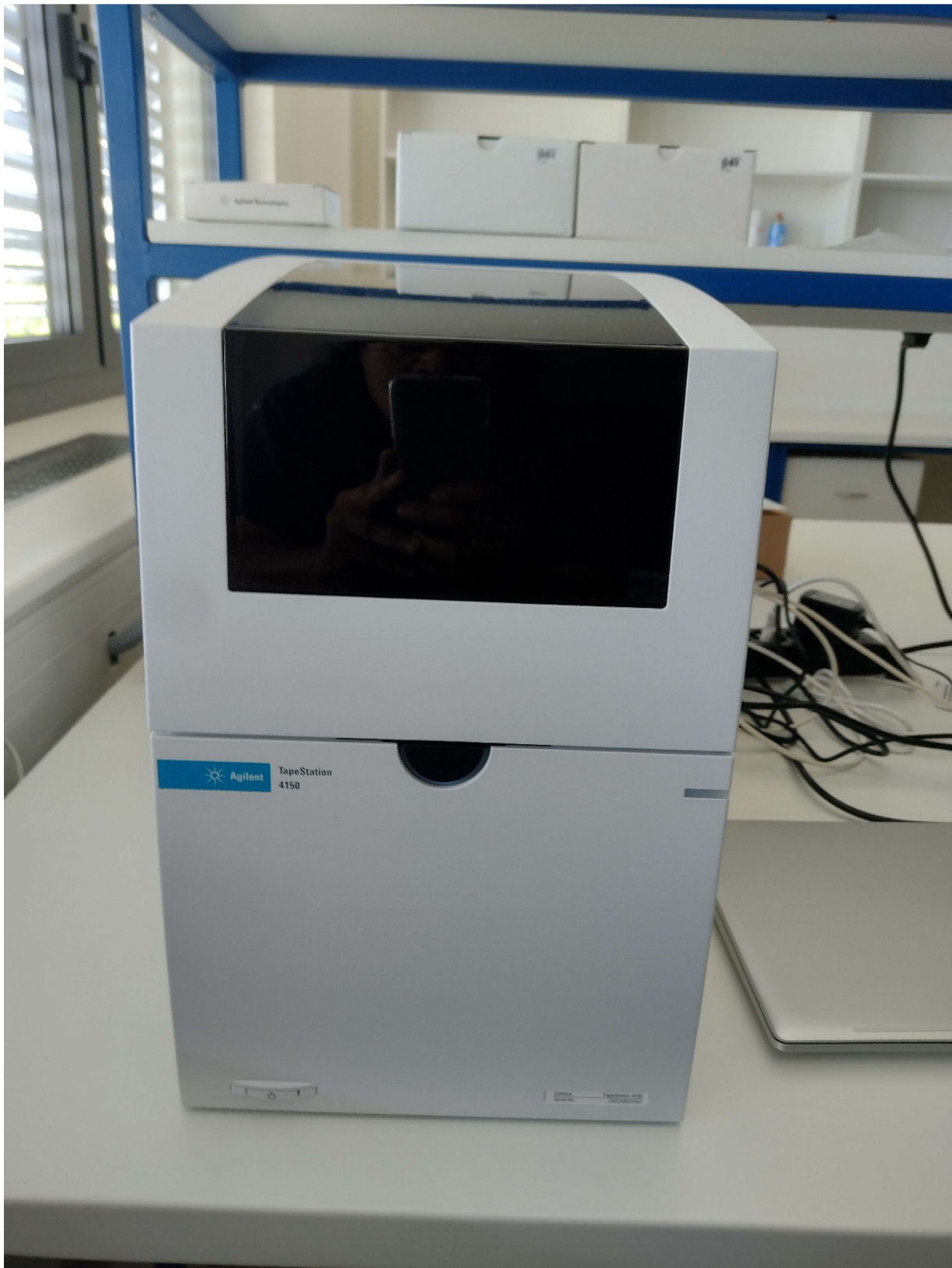
TapeStation: Příklad pro automatickou a rychlou kontrolu kvality a kvantity vzorků DNA a RNA
